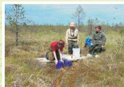
Измерение эмиссии метана и диоксида углерода
