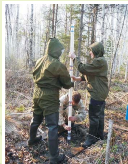
Установка камер для изучения газового режима
