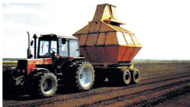
Рис. 1. Экспериментальная машина МТФ-43А на пневмоколесном ходу
